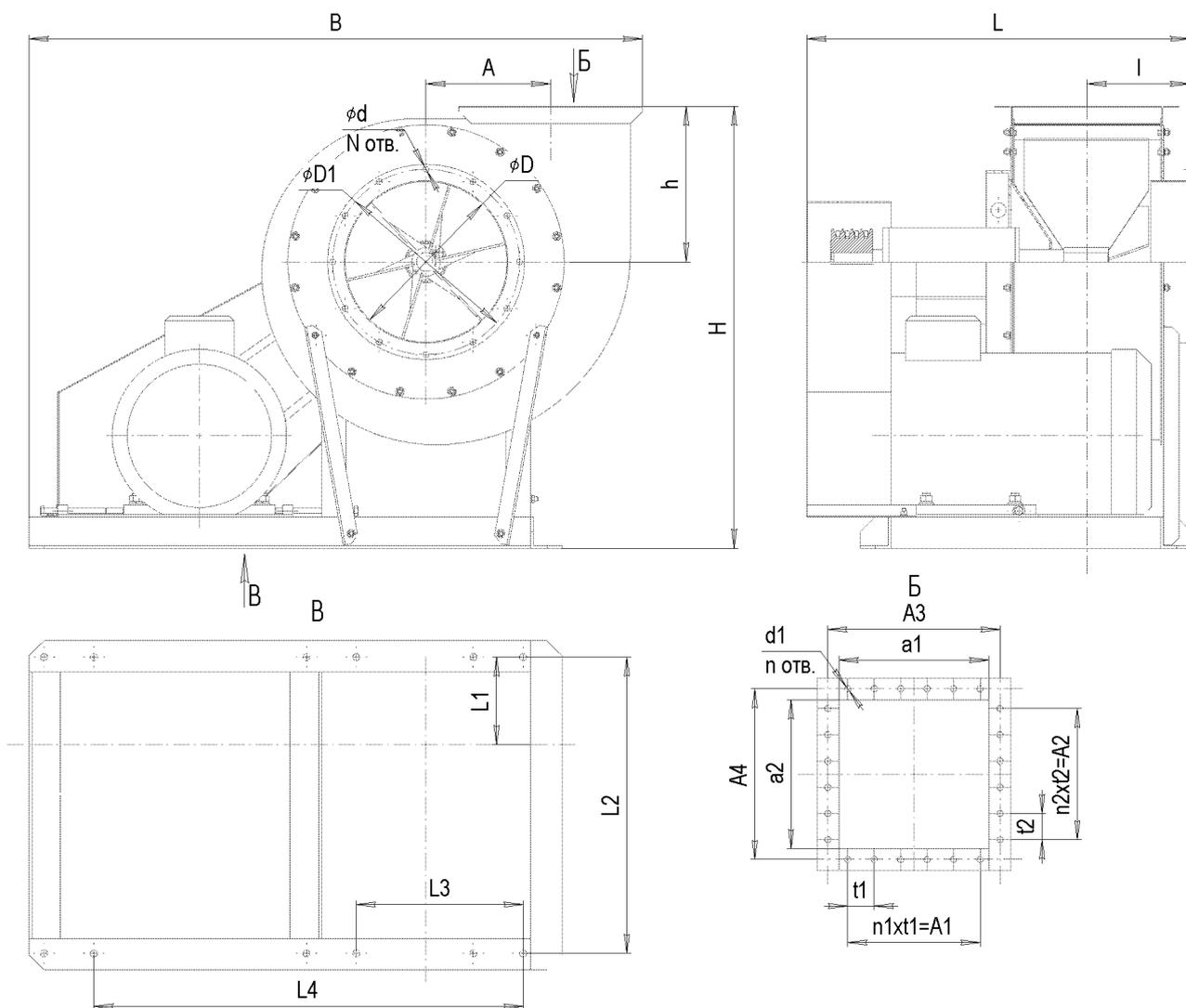
Габаритные и присоединительные размеры вентиляторов ВЦП 7-40 (исполнение 5).
