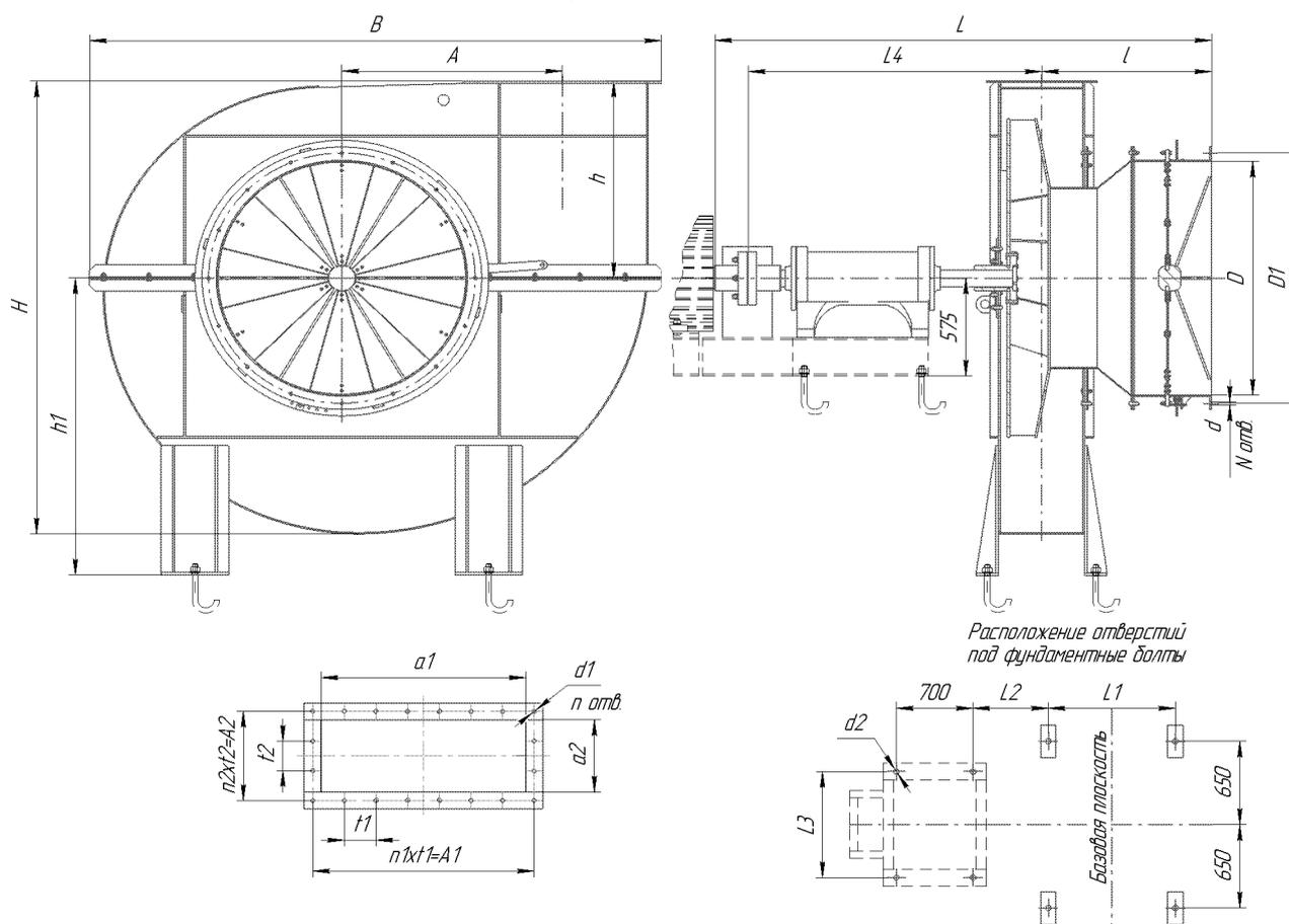
Габаритные и присоединительные размеры тягодутьевых машин ВМ №15;17 исполнения 3.
