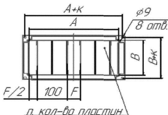
Шумоглушители пластинчатые ШГп представляют собой сборную секцию, состоящую из металлического кожуха длиной 1000 мм с размещенными внутри него пластинами, зафиксированными при помощи заклепок в направлении движения воздуха, указанном на чертеже стрелкой.
