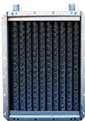
Калориферы имеют теплоотдающие трубки  $Dn16 \times (1,5 \div 2,8)$  мм с оребрением стальной лентой толщиной 0,5 мм.
